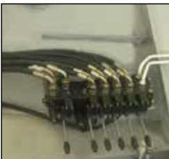
bom kumanda manuel ünitesi manual boom control unit pompa bollarını manuel olarak kumanda eder / activates boom of pump manually
